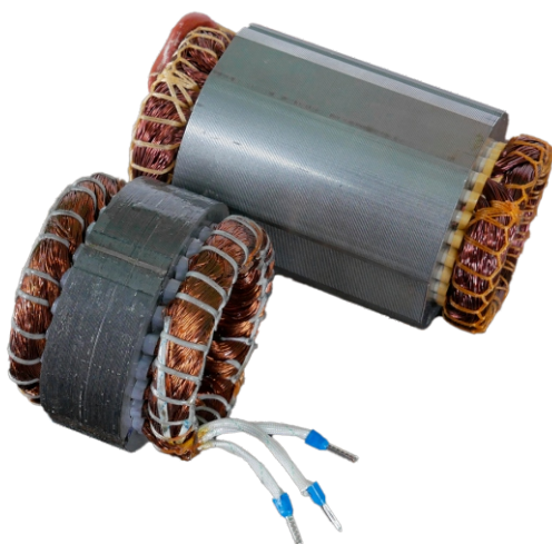
A „Sovelmash” gérvágófűrész és egy szabványos tekercselésű motor állórészének összehasonlítása
