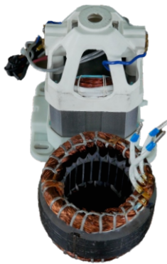
A fűnyíró sztátorainak összehasonlítása: „Sovelmash” aszinkronmotor (az előtérben), mögötte egy kollektoros fűnyíró motorja
