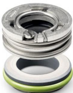
течки, а запатентованная пружина Griplock, затягивающаяся вокруг вала, обеспечивает осевую фиксацию и передачу крутящего момента. Кроме того, конструкция Griploc™ упрощает быстрый и правильный монтаж и демонтаж.
