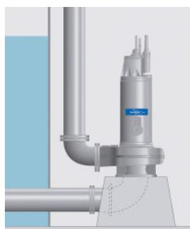
Вертикальная стационарная установка в сухом отделении или линейная установка с фланцевыми соединениями для всасывающих и нагнетательных трубопроводов.
