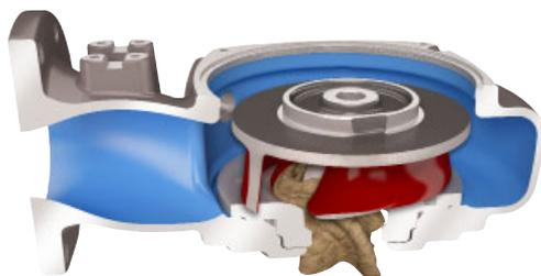
Этап 1. Большинство твердых предметов, попадающих в насос, проходят сквозь рабочее колесо между его лопастями. Если предмет задерживается на передней кромке одной из лопастей, то он соскользнет вдоль загнутой назад кромки к периметру впуска.
