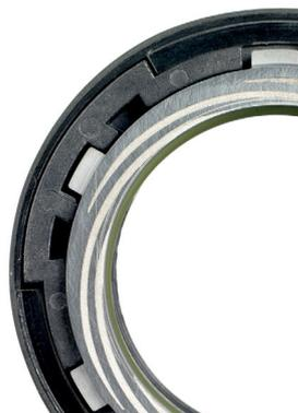
Система Active Seal™ представляет собой запатентованное двойное уплотнение, исключающее протечки. Она активно предотвращает проникновение жидкости в полость двигателя, тем самым снижая риск повреждения подшипника и статора. Система имеет уникальное внутреннее уплотнение, действующее как микронасос, и внешнее уплотнение, предотвращающее протечку перекачиваемой жидкости в буферную камеру.
