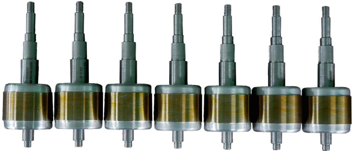
Rotors pour entraînement intégré universel développé par "Sovelmash"
