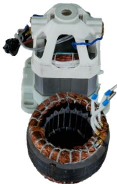
*Confronto di statori per tosaerba: motore asincrono Sovelmash (in primo piano), in secondo piano c'è il motore a collettore di un tosaerba*
