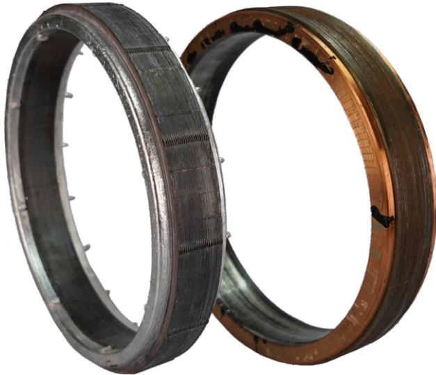
*Prototipi di rotori di motori a induzione invertiti: a destra - primo esempio con gabbia di scoiattolo in rame, a sinistra - nuovo esempio con gabbia di scoiattolo in alluminio fuso*
