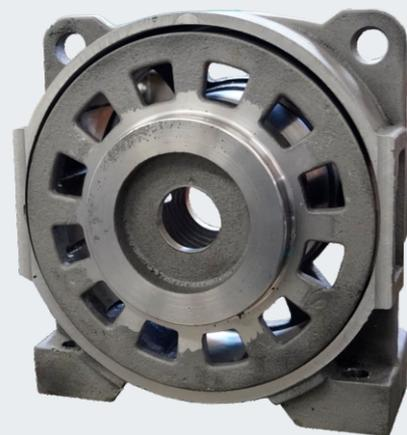
*Corpo del rotore nel corpo dello statore*
