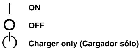
Al poner el conmutador en "on", el producto es plenamente operativo. El inversor se pone en marcha y el LED "inverter on" (inversor activado) se enciende.
