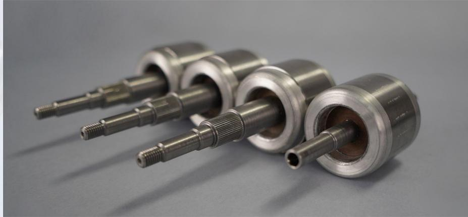
**DEU-SE A FUNDIÇÃO DE ROTORES CURTO-CIRCUITADOS PARA MOTORES DESTINADOS A ELETRODOMÉSTICOS E FERRAMENTAS A MOTOR PORTÁTEIS. PRODUÇÃO DE PRODUTOS DE ELEVADA QUALIDADE E LIVRES DE COMPOSTOS DE ÓXIDOS**
