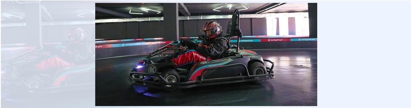
**O FABRICANTE DE KARTS DE MOSCOVO ENTROU EM CONTACTO COM A “STIIN” COM VISTA À ENCOMENDA DE UM KIT ELÉTRICO PARA SUBSTITUIR O MOTOR DE COMBUSTÃO INTERNA. NO KART FOI EQUIPADO UM KIT CRIADO COM BASE NUM MOTOR DA-90SM JUNTAMENTE COM UMA VENTONINHA DE ARREFECIMENTO**
