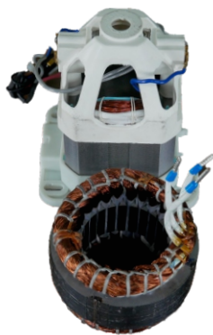
Сравнение на статори за косачка на трева: асинхронен двигател на «Совэлмаш» (на преден план), зад него е колекторен двигател на косачка
