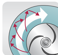
Стандартное рабочее колесо не предполагает однородность потока.
