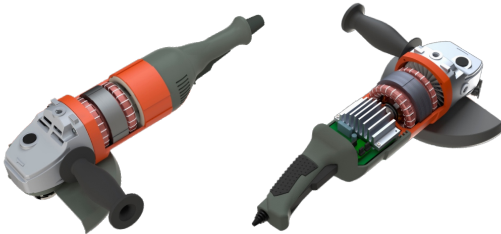
Gerinda sudut (tanpa komutator, tanpa magnet permanen) 2,3 kW dengan motor induksi dan pengendali buatan "Sovelmash"
