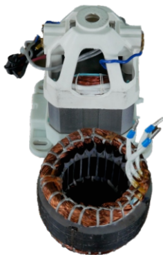
Membandingkan stator untuk mesin pemotong rumput: motor induksi "Sovelmash" (di latar depan), diikuti oleh motor mesin pemotong rumput komutator
