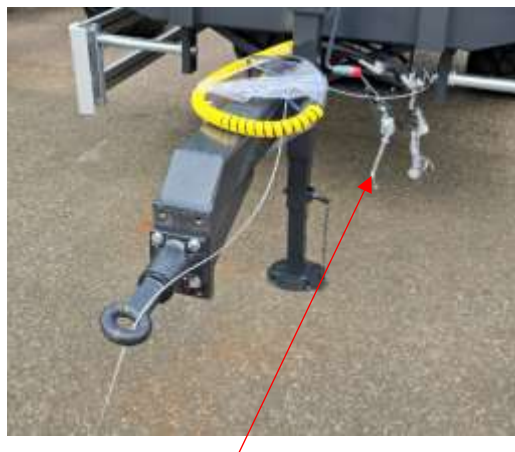
Vev för att spänna/släppa handbroms när kärren är parkerad
