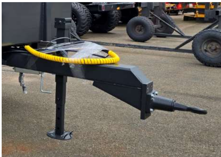
Kärran på bilden är utrustad med vevbar stödfot och bultad hitchögla
