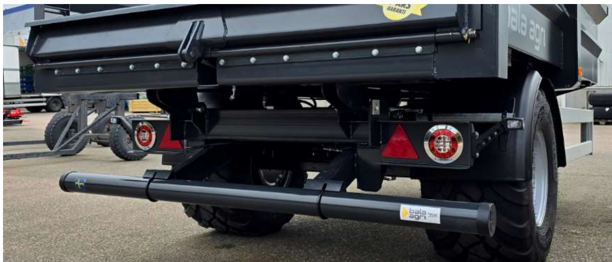
Kärnan på bilden är utrustad med påkörningsskydd, hydraulisk grusläm och sidobelysning
