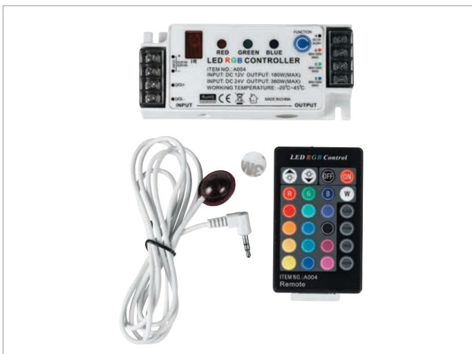
Art. STRIP-RGB-CONTROL-XL Ricevitore multientrata + telecomando RGB 12V per strip INPUT DC 12V - 24V MISURE 120X51X27MM INPUT 12V 15A MAX 180W - INPUT 24V 15A MAX 360W IP20 8031434521214
