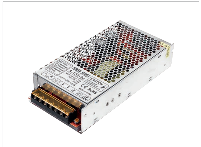
Art. STRIP-DRIVER 12V-75W Adattatore tensione costante 12V 75W Multientrata output 12V 6A INPUT 100-240V 2.0A Misure 125X100X37MM IP20 CLASSE I 8031439581268
